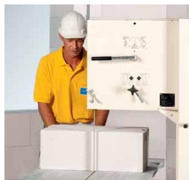
Резка с использованием ленточной пилы
